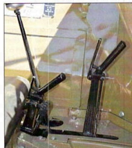
Die Schaltthebel, für kurze oder lange Gänge, und, rechts, die Handbremse.
